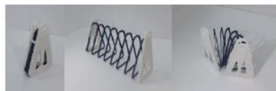
[그림8] 인장 스프링구조의 3D프린팅 프로토타입
