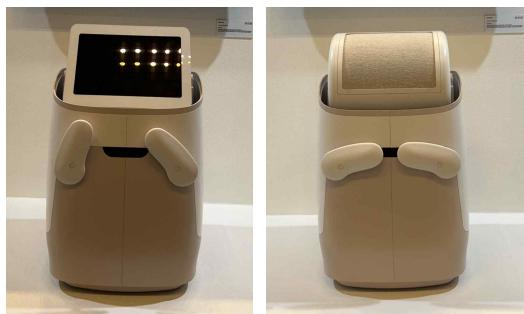
1:1 스케일 목업을 완성하였으며, 부품이 실장된 상태. 구동 모터를 통해 이동이 가능하다. 양쪽손은 모터를 통해 구동되며, 머리의 회전은 현재는 수동이나, 차후에 모터를 통해 회전이 되는 형태로 발전할 예정
